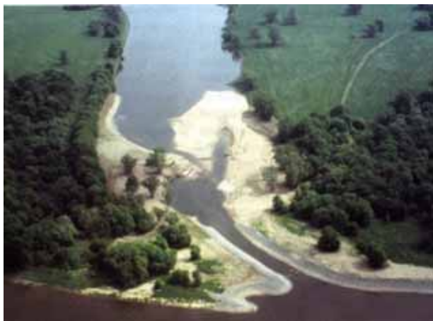
Abb. 6: Kurzer Wurf bei Klieken, Anbindung eines Altarmes an die Elbe (Foto R. Apel nach Jährling 2009)
