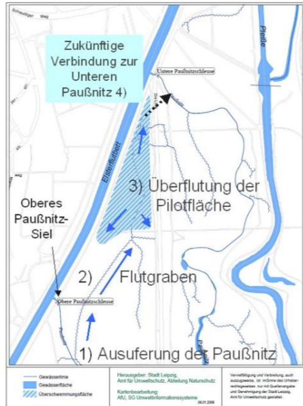
Abb. 3: Pilotprojekt „Paußnitz-Flutung“: Im Norden des NSG „Elster- und Pleiße- Auwald“ wird seit 1993 die sogenannte experimentelle Flutung durchgeführt. Jährlich zu Beginn der Schneeschmelze wird das Obere Paußnitz-Siel für etwa 2 Wochen geschlossen. Das ansteigende Wasser tritt von der Paußnitz (1) in den Flutgraben (2) über, fließt von dort in die tiefergelegene Pilotfläche nach Norden und bildet eine Überschwemmungsfläche von 3 bis 4 ha (3). Durch die Schaffung eines Verbindungsgrabens von der Pilotfläche zur Unteren Paußnitz (4) kann in der bisher stagnierenden Überflutungsfläche ein Durchfluss hergestellt werden. Der Flutgraben (2) ist bei geschlossenem Oberen Paußnitzsiel auch als ständiger Bachlauf zu betreiben.
